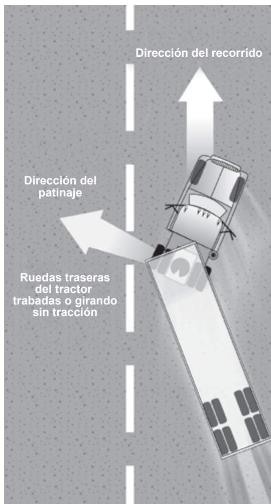
Figura 2-21: Doblaje de tractor (jackknife)
