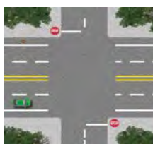
Cruces peatonales no marcados
